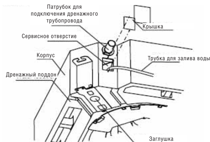
Рис. № 11. Монтаж дренажного трубопровода.
