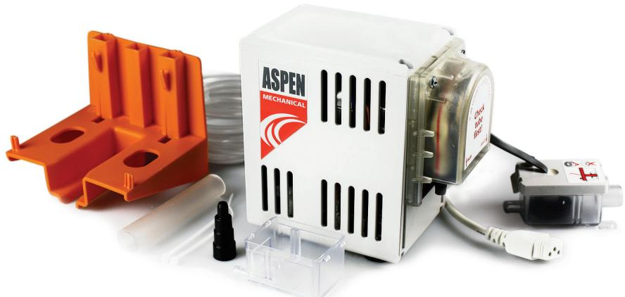
Объединение перистальтической технологии и технологии мини-помп. Просто поместите поплавковый датчик в поддон для сбора конденсата или прикрепите его к патрубку сливной трубы (в зависимости от выбранного резервуара). Доступен вариант с выводом сигнала на отключение кондиционера.
