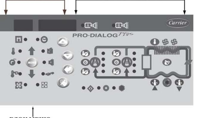
Местный интерфейс позволяет отображать и модифицировать ряд рабочих параметров. Интерфейс состоит из двух различных частей: главный интерфейс (левая часть) и сводный интерфейс (правая часть).
