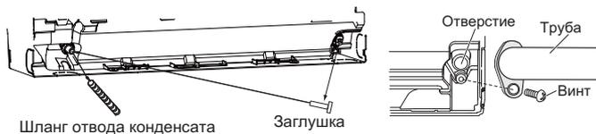
Подключите отвод конденсата к трубопроводу (наружный диаметр дренажной трубы 16 мм).
