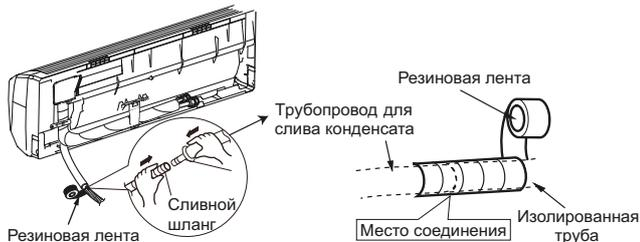
Изолированная труба отвода конденсата должна иметь надежное крепление. Не допускаются провисы и подъемы. Пример монтажа смотри ниже.
