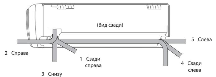
1. Просверлите в стене отверстие диаметром 65 мм для прокладки коммуникаций.
