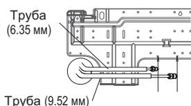
Наденьте внутренний блок на специальные кронштейны на монтажной панели. Убедитесь, что они вошли в предназначенные для этого пазы в задней части корпуса блока. Опустите нижнюю часть блока, слегка надавите на блок и прижмите его к стене, чтобы нижние фиксаторы монтажной панели вошли в зацепление с защелками на корпусе блока.
