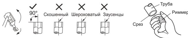
(3) Наденьте развальцовочную гайку (всегда используйте развальцовочную гайку, прикрепленную к внутреннему и внешнему модулю соответственно) на трубу и развальцуйте трубу при помощи развальцовочного инструмента. При использовании других развальцовочных гаек может возникнуть утечка хладагента.
