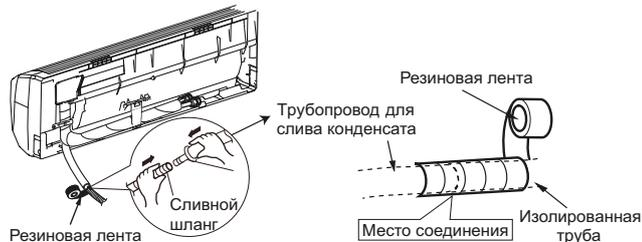
Изолированная труба отвода конденсата должна иметь надежное крепление. Не допускаются провисы и подъемы. Пример монтажа смотри ниже.
