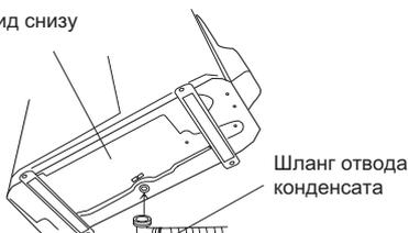
⚠ **ВНИМАНИЕ.** Отведение дренажа от наружного блока используется только при температура наружного воздуха выше 0 °С.
