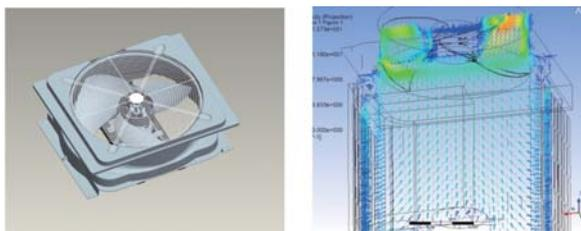
2. Аэродинамический 3D-расчет профиля крыльчаток. Новый вентилятор обладает производительностью на 12% больше, по сравнению с вентилятором стандартной конструкции при одновременном снижении уровня шума.
