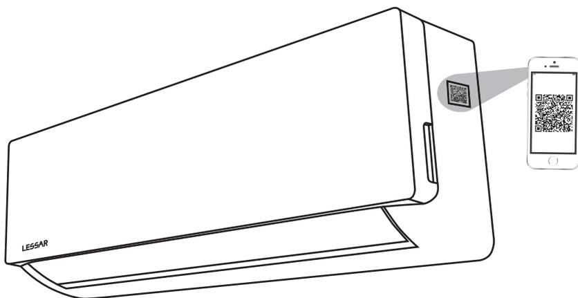
Система управления примет код, и попросит переключить Wi-Fi на смартфоне в режим поиска сети и найти сеть с названием net\_ac\_xxxxx (где xxxx код устройства).
