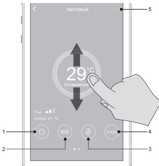
На экране обозначены текущая система (тестовый), текущая настройка температуры (29 °C), действующий режим работы (охлаждение), скорость вентилятора, температура воздуха в помещении. Также в нижней части расположены иконки, позволяющие менять режимы работы кондиционера:
