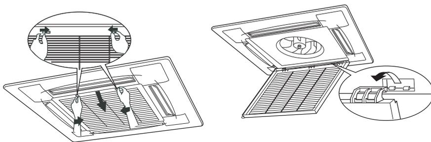
2. Смывайте грязь с сетки фильтра с помощью мягкого моющего средства, тряпочки и воды до тех пор, пока вы не увидите ни одной пылинки
