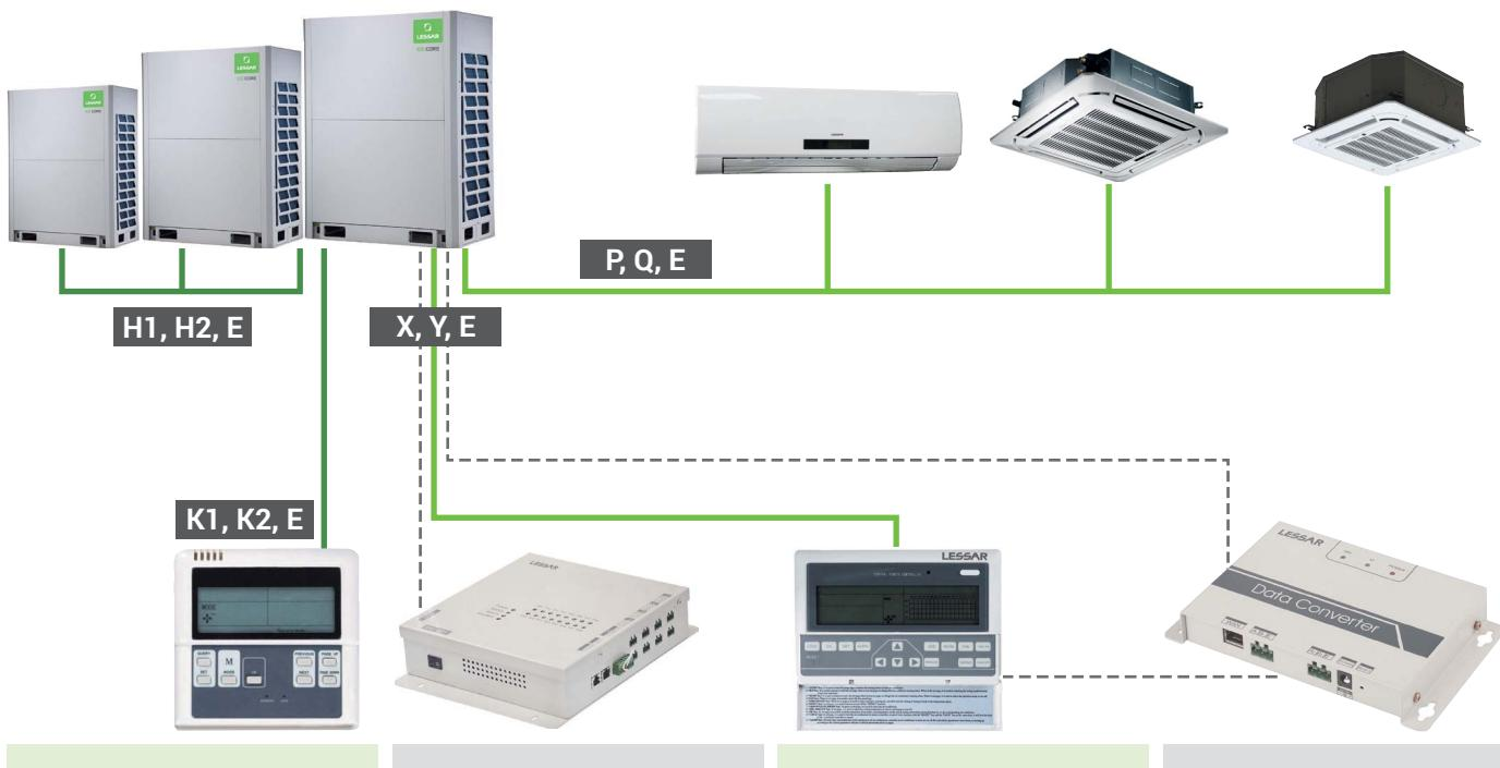
**Пульт управления для наружных блоков (до 8 систем и до 32 наружных блоков)
