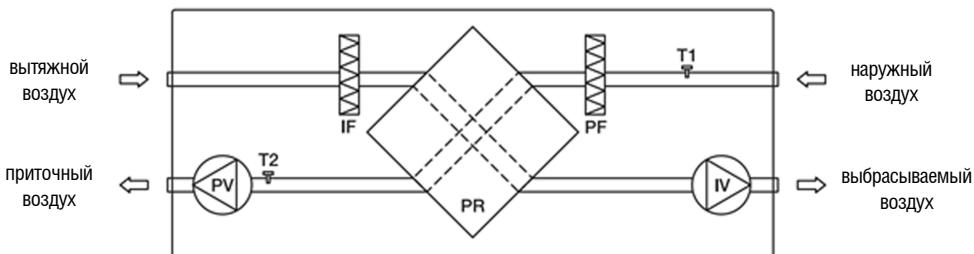
Pv – вентилятор приточного воздуха, IV – вентилятор вытяжного воздуха, PR – пластинчатый рекуператор «Sensitive», PF – фильтр наружного воздуха, IF – фильтр для вытяжного воздуха, T1 – датчик температуры наружного воздуха, T2 – датчик температуры приточного воздуха.
