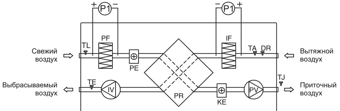
PV — вентилятор приточного воздуха;
